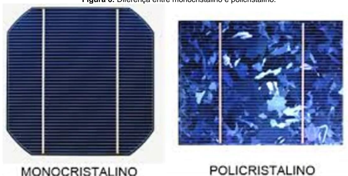
Figura 6: Diferença entre monocristalino e policristalino.
