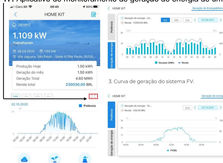
Figura 17: Aplicativo de monitoramento de geração de energia de um inversor.
